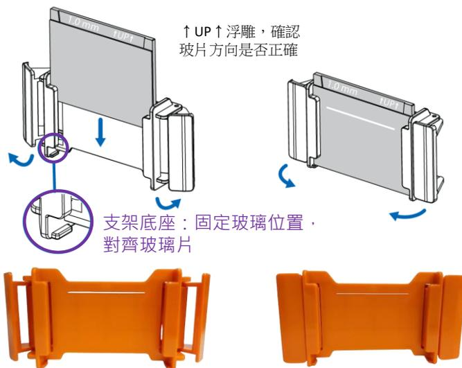
按壓製膠基座彈簧夾，並卡入含玻璃之製膠支架，將其夾緊
