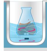
內建攪動桿及磁力攪動器，均勻攪拌
